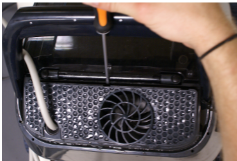
7.1. Utilisez un tournevis plat pour retirer la grille de protection.
