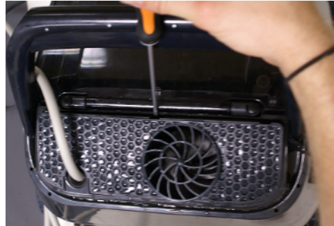
8.1. Das Schutzgitter entfernen Sie mit einem flachen Schraubenzieher.
