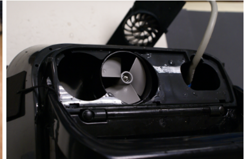
8.2 Reinigen Sie das Laufrad. 8.3 Das Schutzgitter einsetzen.
