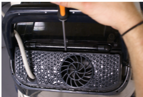
7.1. Das Schutzgitter entfernen Sie mit einem flachen Schraubenzieher.
