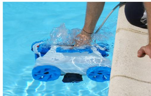
4.2 Coloque el robot en su piscina y espere hasta que esté totalmente sumergida. Si es necesario, ayúdelo a hundirse manualmente.
