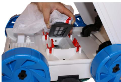
7.5 Tire los residuos de la bolsa. Use una manguera para rociar con agua y limpiar la bolsa.
