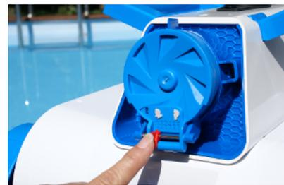
6.2 Para ajustar la velocidad del robot use un destornillador y gire el tornillo de la parte inferior de la tapa. Si lo desatornilla aumentará su velocidad y si lo atornilla la disminuirá.
