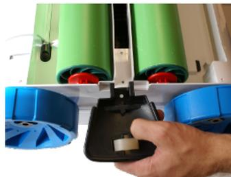
8.2: Coloque las solapas en el robot limpiador como se muestra.
