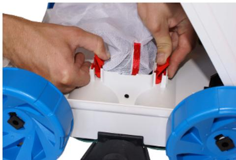
7.2 Tire de las pestañas rojas de un lado y levante completamente el marco de la bolsa de ese lado.
