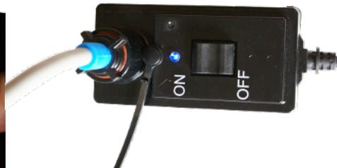
4.5 Pulse el interruptor de la armazón del transformador bajo la luz azul. Esto activará la fuente de energía.
