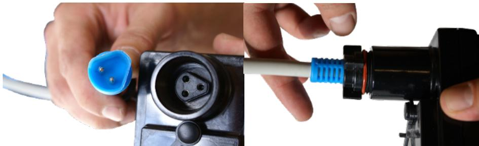
4.3 Inserte el extremo del cable flotante en el enchufe. Tenga cuidado con la orientación de la clavija y el enchufe.
