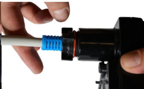
4.4 Atornille la tuerca del cable flotante firmemente.
