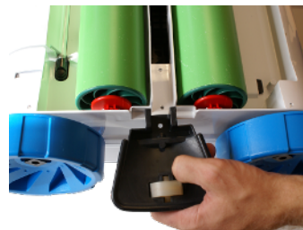
8.2: Legen Sie die Klappen wie gezeigt auf den Pool-Reinigungsroboter.
