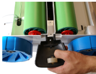
8.2: Insérez les extensions sur le robot comme illustré ci-dessus.
