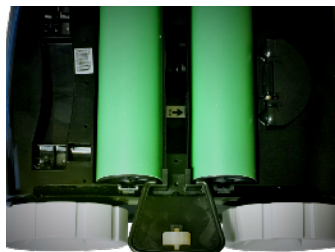
8.2: Coloque las solapas en el robot limpiador como se muestra.
