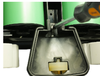
8.3: Asegúrelas con los tornillos que se proporcionan.
