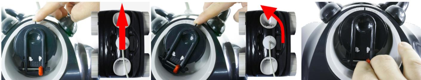
6.1 Per regolare la direzione del robot, ruotare il coperchio di uscita. La direzione del robot sarà determinata dalla posizione dell'indicatore.
