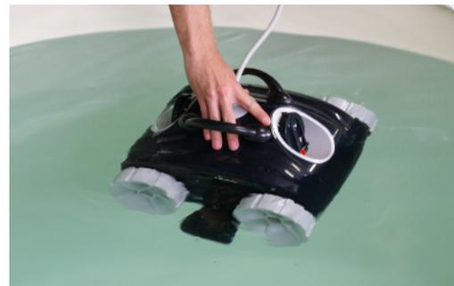
4.7 Metti il robot nella tua piscina e aspetta che sia completamente sommerso. Se necessario, aiutalo a sincronizzare manualmente.
