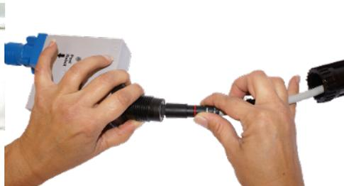
4.2 Inserisce l'estremità del cavo galleggiante del trasformatore nella presa nera "POWER". Attenzione al senso della presa.
