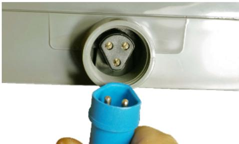
4.1 Inserisce l'estremità del cavo galleggiante nella presa. Prendi nota dell'orientamento della spina e della presa.
