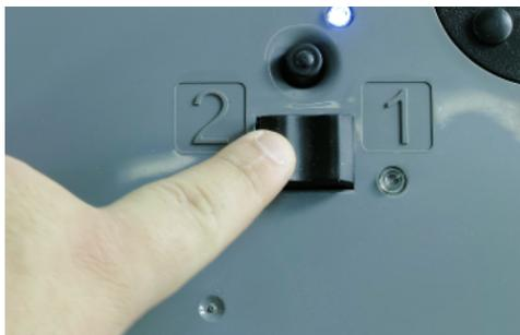
4.8 Premere l'interruttore sull'alloggiamento del trasformatore sotto la luce blu. Questo attiverà la fonte di energia.
