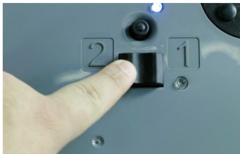
4.8 Drücken Sie den Transformatorschalter unter das blaue Licht. Dadurch wird das Steuerfeld aktiviert.
