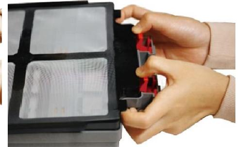
7.3 Ziehen Sie die roten Laschen auf einer Seite zurück und heben Sie den Beutelrahmen an dieser Seite vollständig an.
