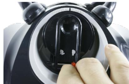
6.2 Um die Geschwindigkeit des Roboters einzustellen, schieben Sie die rote Lasche an der Unterseite der Auslassabdeckung. Schieben zum Kaninchen erhöht die Geschwindigkeit und Schieben zur Schildkröte verringert die Geschwindigkeit des Roboters.
