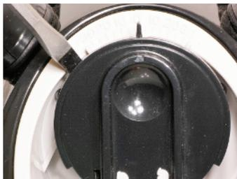
9.1: Entfernen Sie die Klappeneinheit, um den Schmutz oder die Haare am Impeller zu reinigen
