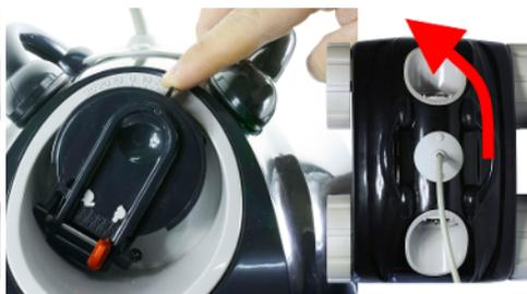
Hinweis: Wenn der Anzeiger in vertikaler Position verbleibt, fährt der Roboter geradeaus. Wenn man der Anzeige rechts gedreht ist, wird der Roboter nach links gehen. Wenn man der Anzeige rechts gedreht ist, wird der Reiniger rechts gehen.
