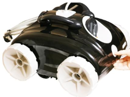
7.1 Pressez sur le bouton situé devant le robot et soulevez le couvercle. Continuez à soulever le couvercle jusqu'à ce que vous entendiez un "click" au niveau des charnières et que le couvercle reste en position haute.
