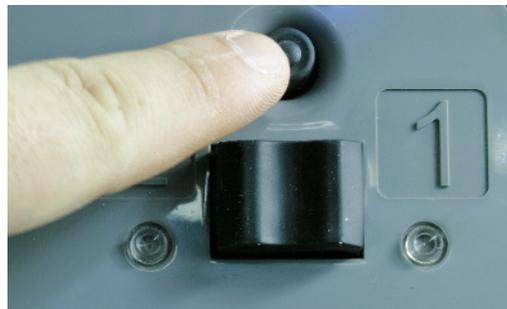
4.9 Pressez sur le bouton au dessus de l'interrupteur pour mettre en marche le robot.
