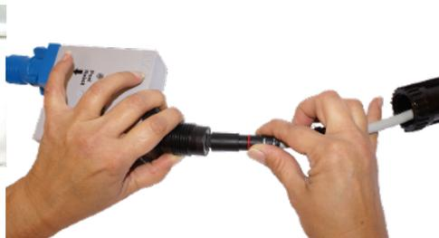
4.2 Insérez l'extrémité du câble flottant venant du transformateur dans la prise noire notée "POWER". Attention au sens de la prise.
