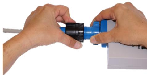
4.5 Répétez l'opération du côté bleu marqué "POOL ROBOT" avec le câble venant du robot.
