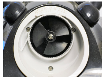
9.3: Klik de klep terug na het reinigen
