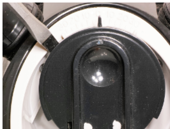
9.1: Verwijder de flapmontage om het vuil of haar op de waaier te reinigen
