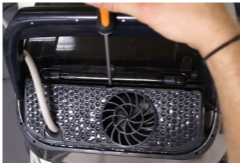
7.1. Use un destornillador plano para quitar la rejilla protectora.
