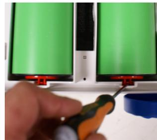
9.2: Wenn Fremdkörper nicht leicht zugänglich sind, verwenden Sie einen flachen Schraubenzieher, um die Rollen vorübergehend zu entfernen. Drücken Sie die Lasche wie im Bild gezeigt, um die Laufrollen zu entfernen.
