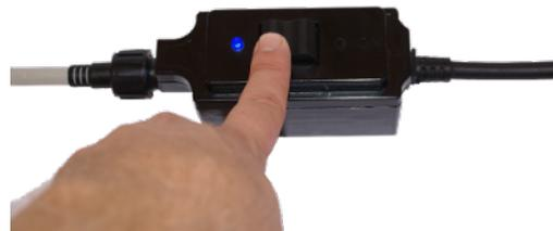
4.9 Drücken Sie den Schalter oben auf der Transformator, um den Roboter zu starten. Die blaue LED über dem Transformator leuchtet auf.
