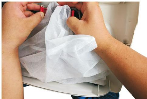
7.2 Ziehen Sie die roten Laschen auf einer Seite zurück und heben Sie den Beutelrahmen an dieser Seite vollständig an.
