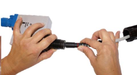
4.2 Stecken Sie das Ende des vom Transformator kommenden Schwimmkabels in die schwarze "POWER"-Buchse. Achten Sie auf die Ausrichtung des Steckers.
