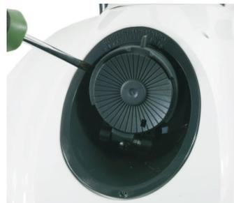
8.2: Verwenden Sie einen flachen Schraubenzieher, um die Klappeneinheit wie gezeigt auszurichten
