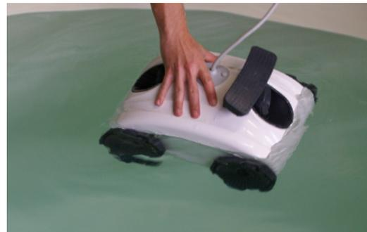
4.7 Legen Sie den Roboter in den Pool und warten Sie, bis dieser vollständig eingetaucht ist. Bei Bedarf helfen Sie beim versenken manuell nach.
