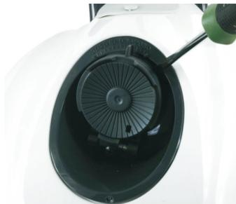
8.1: Entfernen Sie die Klappeneinheit, um den Schmutz oder die Haare am Impeller zu reinigen
