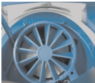
7.1: Verwijder de flapmontage om het vuil of haar op de waaier te reinigen
